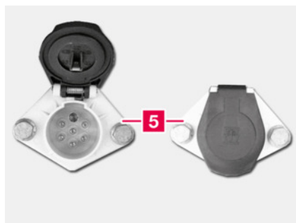
5 Enchufe S para suministro de corriente 24 V, 7 polos
