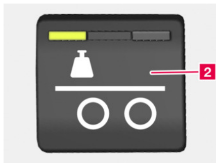
2 Tecla de la ayuda al arranque del 2.º eje trasero propulsado
