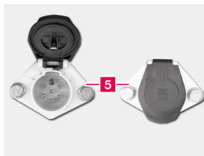
5 Enchufe S para suministro de corriente 24 V, 7 polos
