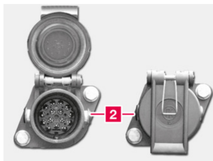
2 Enchufe para iluminación 24 V, 15 polos
