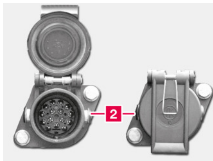
2 Enchufe para iluminación 24 V, 15 polos
