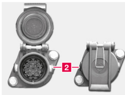
2 Enchufe para iluminación 24 V, 15 polos
