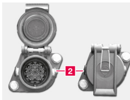
2 Enchufe para iluminación 24 V, 15 polos
