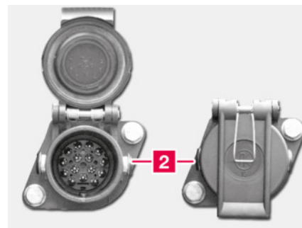
2 Enchufe para iluminación 24 V, 15 polos
